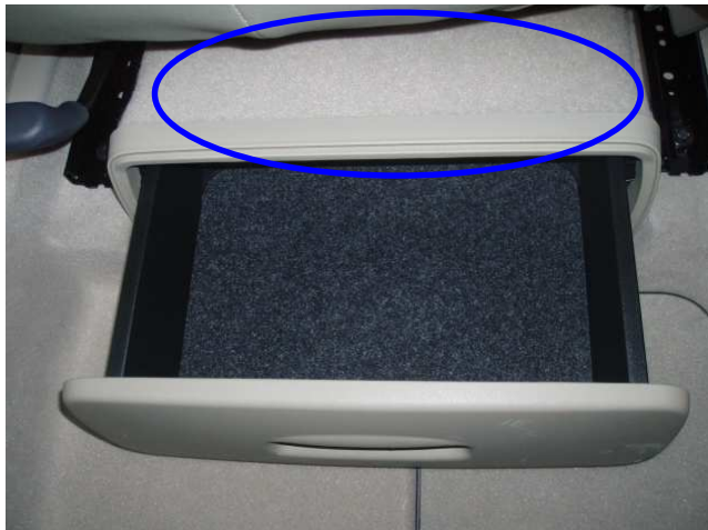
ナビ本体取付位置 ・助手席アンダートレイの中に吊り下げのようにシート下に取り付します。 DVD等の入れ替えはトレイを前にスライドさせて行います。
