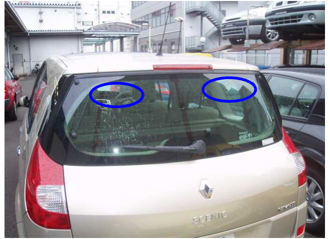
リア用デジタルTVフィルムアンテナ取付位置 ・バックドアガラスに取付します。
