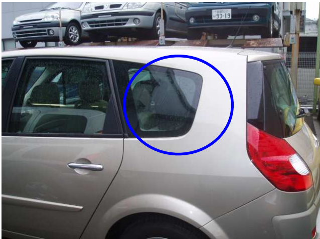
アナログ/デジタルTV兼用アンテナ取付位置 ・左右クォーターガラスに取付します。
