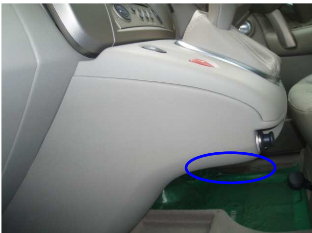
ETC車載器取付位置その1 ・シフトレバー下にブラケットを使用して吊り下げます。 粘着テープでは脱落してしまう為、ブラケットを車両にネジ止めします。
