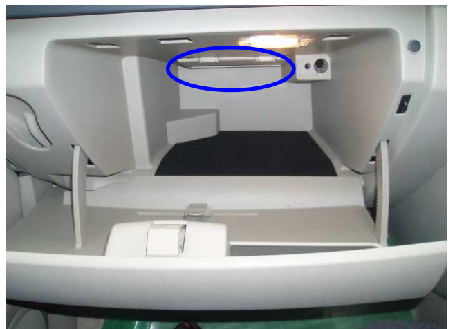
ETC車載器取付位置のそ2 ・グローブボックス内上面に粘着テープで取り付けます。コードは上面に穴をあけて通します。
